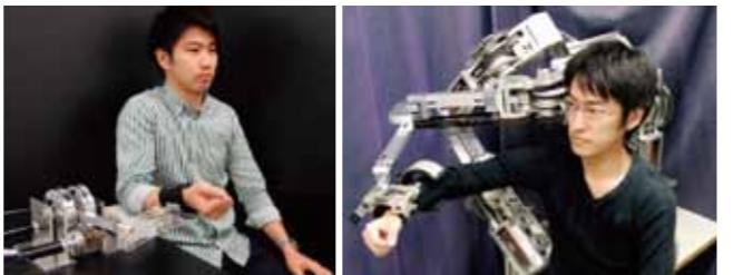
▲脳卒中の人の運動機能回復訓練を支援するリハビリロボットの試作機。動かそうと思う運動意図を脳波で読み取って、ロボットが腕を動かす仕組み。こうすることで、ダメージを受けた脳内の回路にかかる新しい回路が再構成され、機能回復が促進されるという。別途開発した上肢の日常生活動作を誘導・補助するエスクート型リハビリロボットの構成方法を取り入れる予定のこと。
